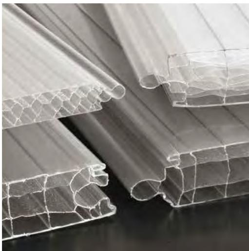
**MODULIT** è un sistema in polycarbonato per la realizzazione di pareti traslucide in tamponamenti verticali nell'edilizia industriale e civile. Il sistema è composto da pannelli estrusi in polycarbonato alveolare con struttura diagonale a 6 pareti, spessore di 40 mm, larghezza modulo di 338 mm e con protezione UV ottenuta in costruzione sul lato esterno. Facile ed economico nella posa, ottima trasmissione della luce, elevata resistenza al carico e isolamento termico.
